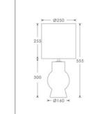
555 mm FULL HEIGHT BASE HEIGHT 300 mm SHADE HEIGHT 255 mm BASE WIDTH 160 mm
